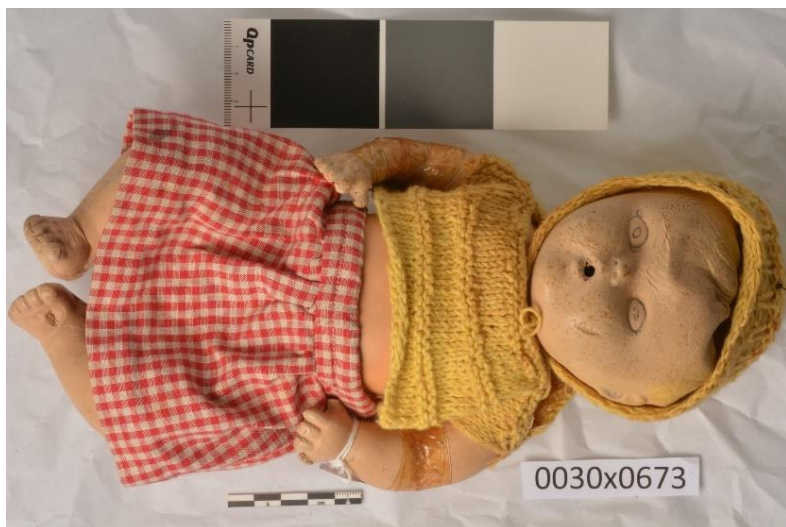
Fig.37. Gummidukke. Gummimaterialet er med en høj andel af fyldstofferne kridt og baryt. Dukken viser forskellige nedbrydningsstadier. Eksponerede overflader er skrumpet, hårde, plettet og sprukket, mens overflader der har været beskyttet af tøj, er i bedre tilstand og stadig relativt bløde. Dukke fra: Mark | Billund Kommunes Museer.
