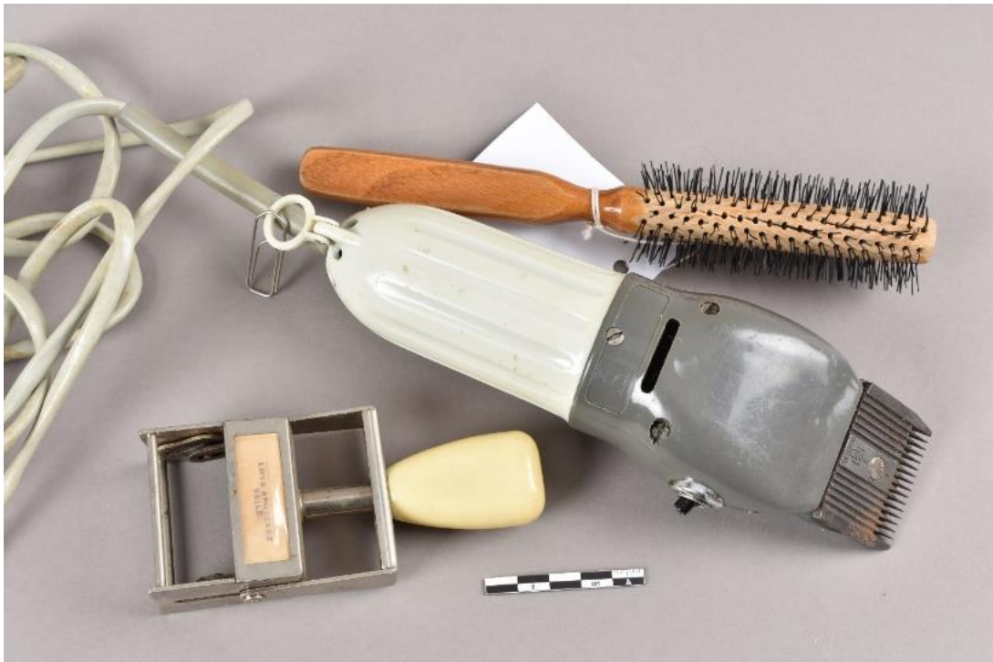
Fig. 43. Træbørste med sorte børster af PA; frisørmaskine med greb af PA; stempel med skaft af PA (transparent plast af CA). VejleMuseerne.
