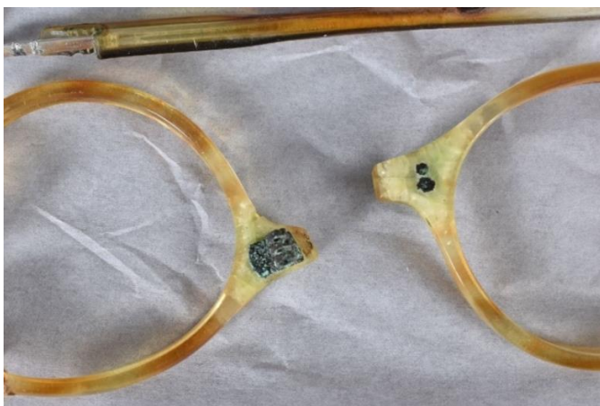
Fig. 10. Celluloidbriller fra Mark | Billund Kommunes Museer. Brillerne er brudte, og metaldele er rustne. Omkring metaldele vandrer kobber-ioner ud i plastdelen og farver det grønt. Bemærk den for celluloid typiske krakelering (se også Fig. 33).
